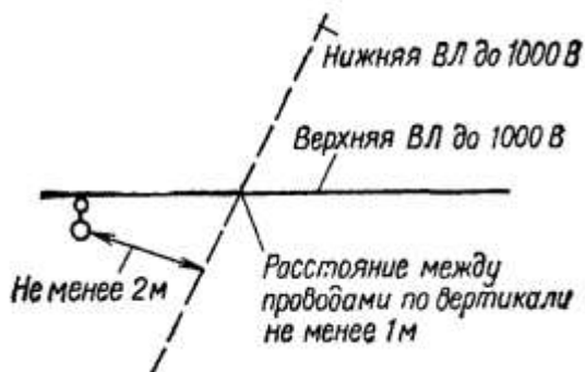
Рис. 1. Схема пересечения в пролете ВЛ до 1 кВ между собой.
