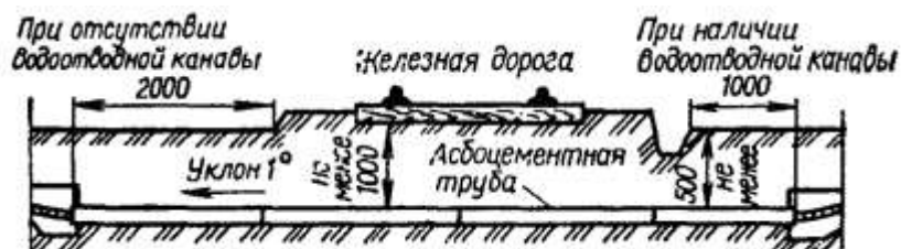
Рис. 3.2.2. Пересечение кабельной линией железной дороги.
